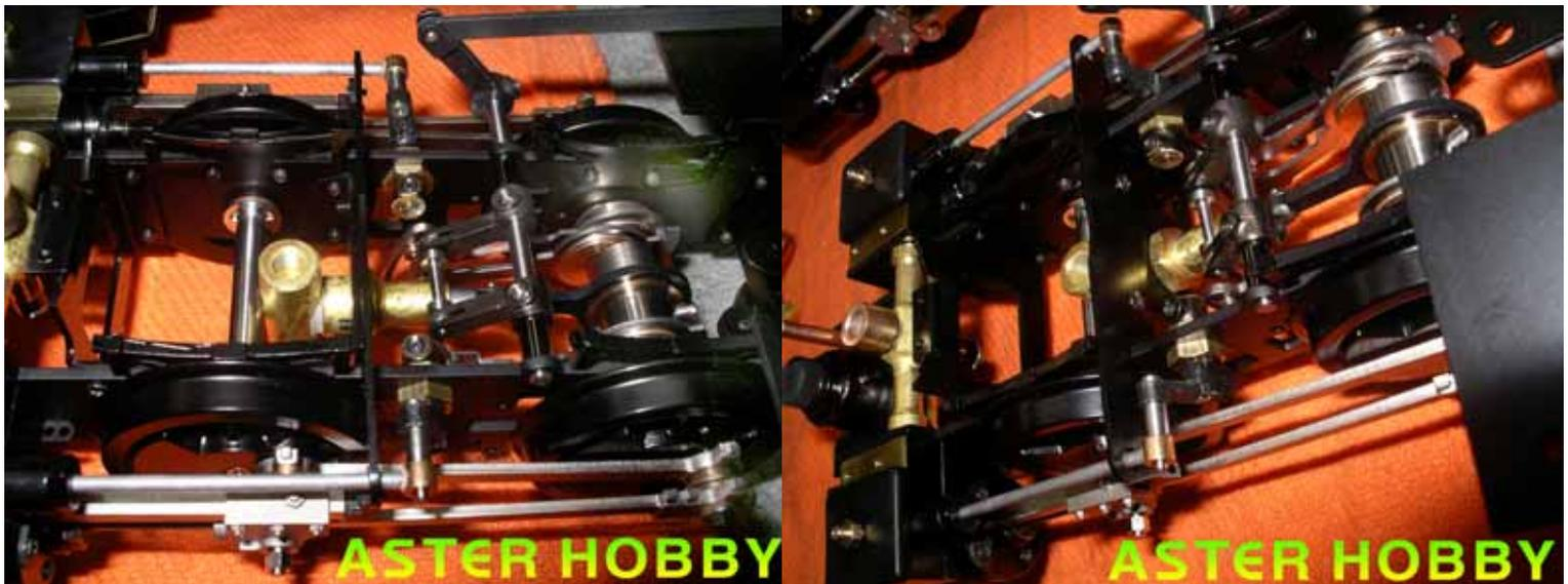
この狭い空間に、実物通りのスティーブンスバルブギヤを再現しました。各部品はかなり小さく、組み立てには、それなりに「コツ」を要し、それなりに精密組み立ての知識と経験が必要ですが、その分、確実に作動すると喜びは、数倍に成って帰って来る事をお約束します。勿論、根気と仕組みへの理解力さえあれば初心者でも確実に組み立ては可能です！
